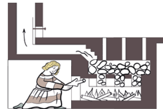
a. Nagrzewanie kamieni od ognia w palenisku przy otwartym kanale dymowym i zamkniętych kanałach wlotowych w pomieszczeniu.
